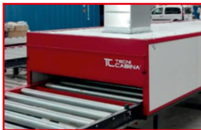
Detalle del transportador de piezas en horno
